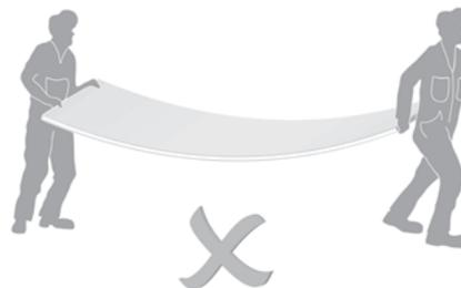
Панели необходимо переносить каждую отдельно, в вертикальном положении, чтобы одна рука поддерживала панель, а другая – контролировала положение. Рекомендуется использовать вакуумные вспомогательные приспособления для переноски грузов.
