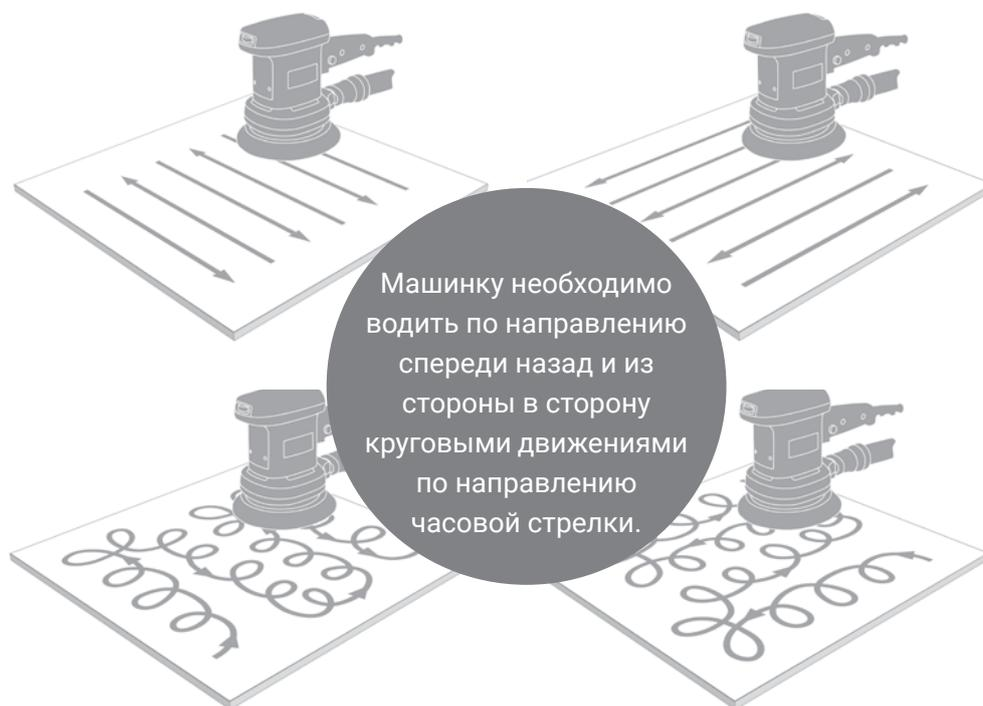
В противном случае после шлифования останутся завитки и царапины. Давление шлифовальной машинки на обрабатываемую поверхность не должно быть большим, т.к. сильное давление приводит к нагреванию шлифовального средства и усложняет обработку Kerrock поверхности ввиду поверхностного слипания снятого шлифованием материала.
