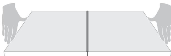
Угловые элементы следует склеивать следующим образом: нанести клей на поверхность и затем прижать наклеиваемый элемент под прямым углом к поверхности. Приклеиваемый элемент закрепить струбцинами или зажимом. Рекомендуем смещать приклеиваемый элемент на 1-2 мм внутрь поверхности. За счет этого получится гладкий край по окончании обработки.
