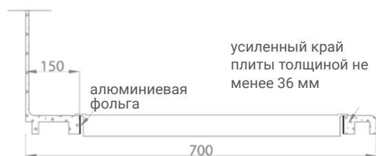
Для столешницы шириной 600 мм можно устанавливать стеновое покрытие из Kerrock материала, но его нельзя жестко крепить к столешнице. Крепить следует эластично, как это показано на рисунке.
