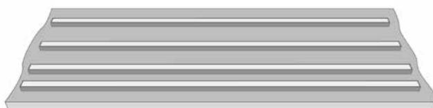
Каркас можно выполнить только с продольным усилением, а именно: установить несущие элементы спереди, посередине и сзади.
