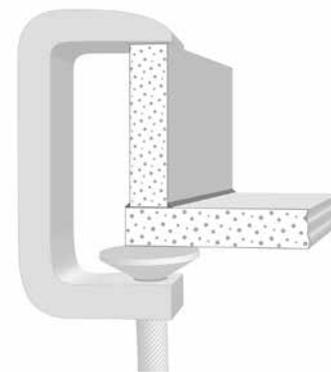
У панелей Kerrock, содержащих металлические частицы (платина, stardust и графит) поверхность и край панели выглядят по-разному, поэтому места соединения необходимо выполнять так, чтобы край панели не был виден. Можно применить один из двух способов:
